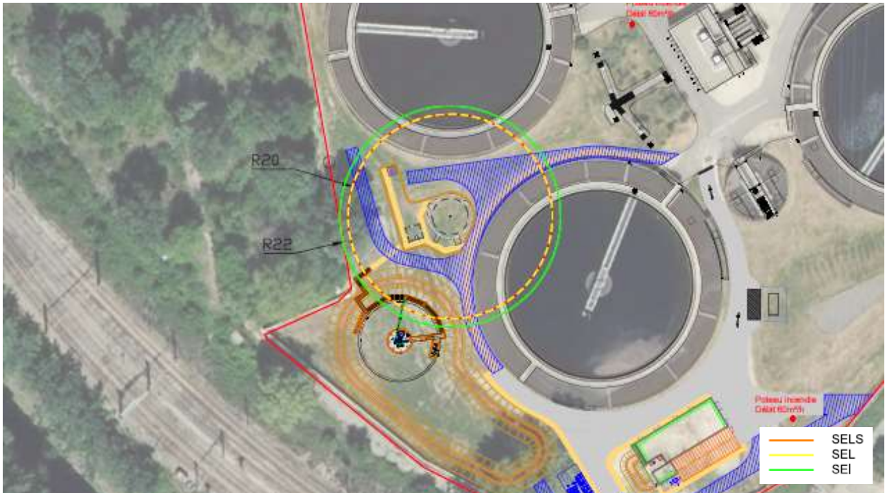
Figure 6 : Distances des effets thermiques liés à une explosion consécutive à la ruine du gazomètre
