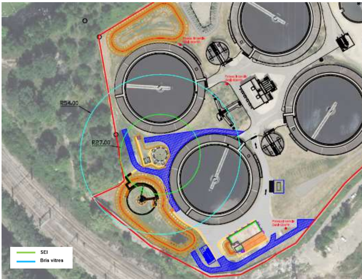
PHD4 : Distances des effets de surpression liés à une explosion de biogaz dans le gazomètre
