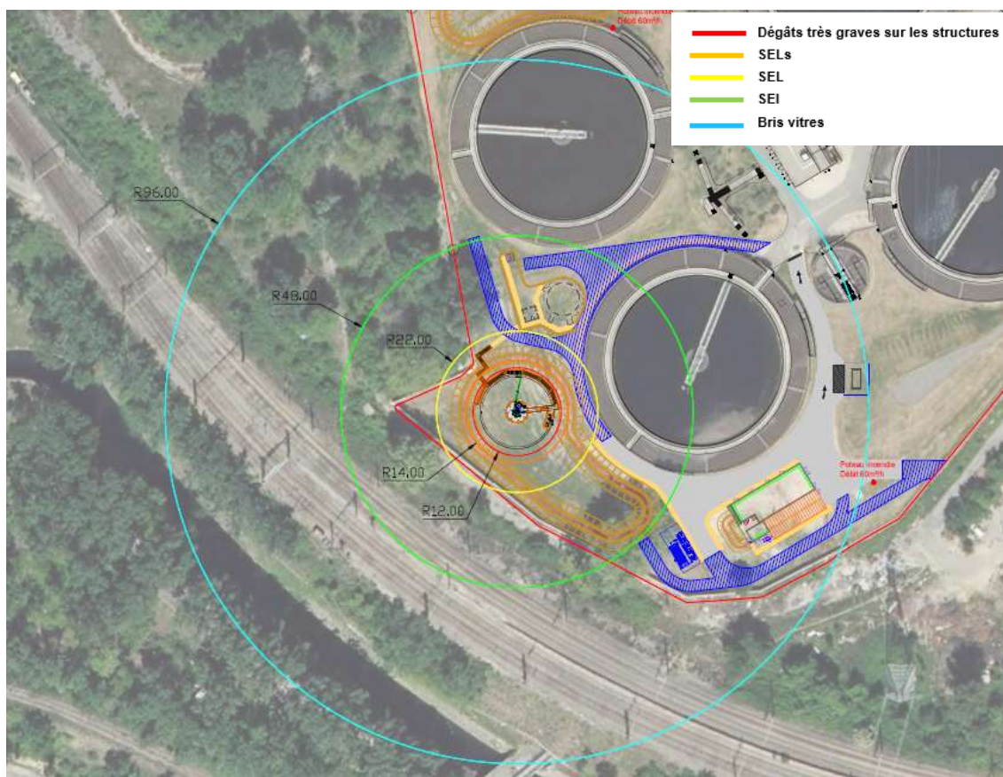
PHD1 - Distances des effets de surpression liés à l'explosion du digesteur plein
